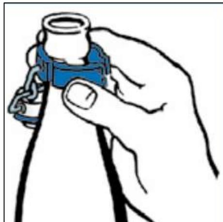
3. Bügelverschluss auf die Mündung setzen und mit dem Zeigefinger herunter drücken.
